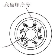
(9) 面板式安装：将导线穿过灯头底座后盖，按底座顺序号焊上导线，焊接时间不宜过长，且焊接的每个端子需套上绝缘套管
