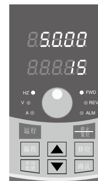
图 4-4 运行参数显示状态 显示运行时输出频率“50.00”
