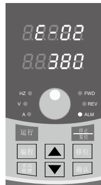
图 4-5 加速中过流故障报警显示
