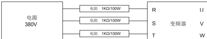
图 9-1 380V 驱动装置充电电路示例
